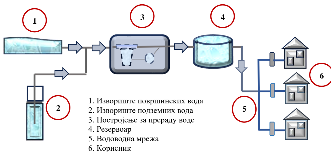
Слика број 2: Упростићена шема водоводног система
